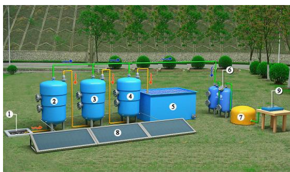
Μονάδα Επεξεργασίας Υγρών Αποβλήτων UASB
